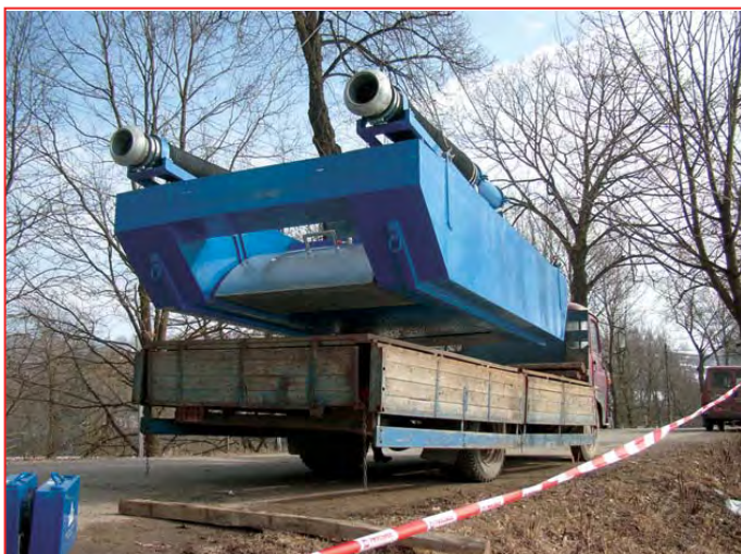
Čerpací prám je dopraven na místo určení na nákladním automobilu
